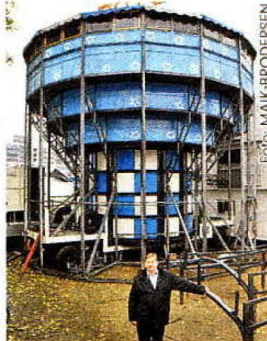
Der „Rotor“: Kesseldurchmesser 4,2 Meter, 28 Umdrehungen pro Minute, Höhe 4,5 Meter, Wert: 1 Million Euro
